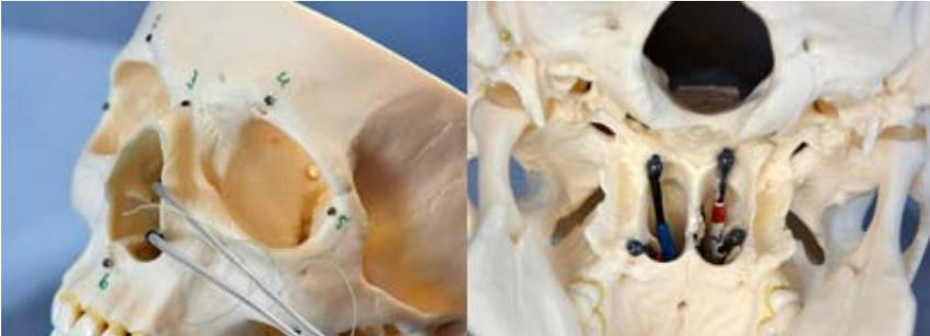
**Abbildung 2:** a) Der verwendete Plastikschädel mit implantierten Titan-Markern. Links sind die drei Kabel zur Sensoren sichtbar. b) Rechts ist in einer posterior-anterioren kaudo-kranialen Ansicht das RS Element dargestellt. In jeder Titankugel ist ein 5D Sensor montiert; der Patiententracker (6D) ist im rechten Nasengang am „knöchernen“ Septum sichtbar.
