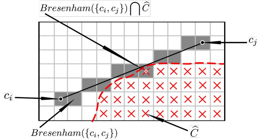
Рис. 5: Пример того, как с помощью алгоритма Брезенхэма определяется факт пересечения ребра  $\{c_i, c_j\}$  с множеством «запретных» вершин  $\widehat{C}$
