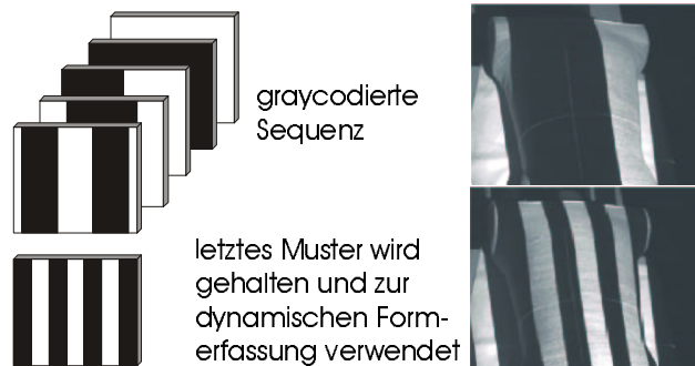
Abb. 1 Graycodierte Muster und zwei Kamerabilder eines Dummys.
