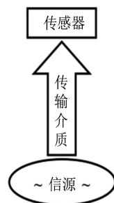
图3 无损检测传感的系统模型
