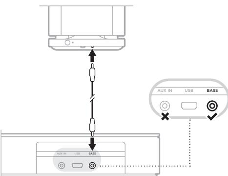
Raccordez un câble audio de 3,5 mm (non fourni) au connecteur BASS IN du module de graves et au connecteur BASS de l'enceinte (et non pas au connecteur AUX IN).
