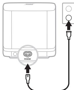
Une fois connecté, le module de graves se met sous tension.
