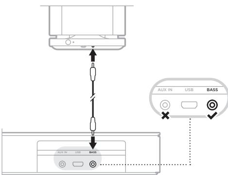
Conecte un cable de audio de 3,5 mm (no suministrado) al conector **BASS IN** del módulo de bajos y al conector **BASS** del altavoz (no al conector **AUX IN**).
