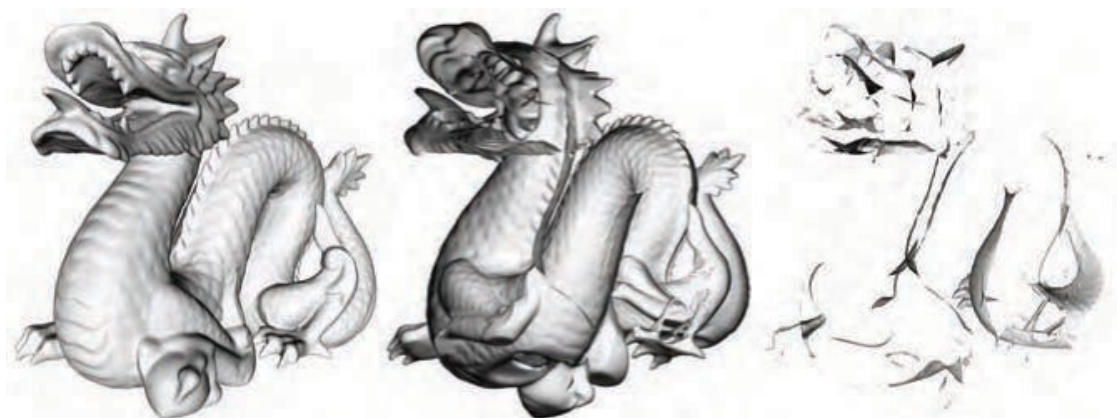
图 6 每个深度剥离通道渲染特定的一层透明通道。左侧是第一个 Pass，直接显示眼睛可见的层，中间的图显示了第二层，显示了每个像素处第二靠近透明表面的像素。右边的图是第三层，每个像素处第三靠近透明表面的像素。
