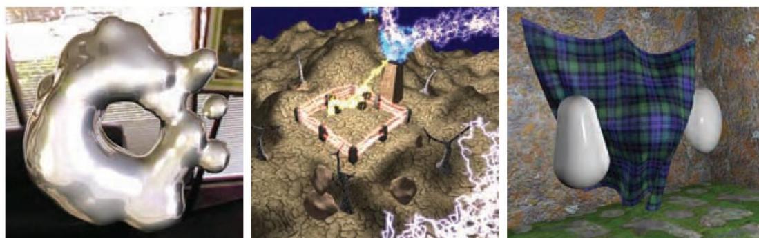
图 3.7.一些几何着色器的应用。左图，使用几何着色器实现元球的等值面曲面细分（metaball isosurface tessellation）。中图，使用了几何着色器和流输出进行线段细分的分形（fractal subdivision of line segments）。右图，使用顶点和几何着色器的流输出进行布料模拟。（图片来自 NVIDIA SDK 10 的示例）
