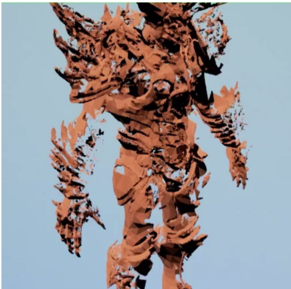
图 41 基于 Splatting 和 voxel 在 Unreal 4 中进行的体渲染
