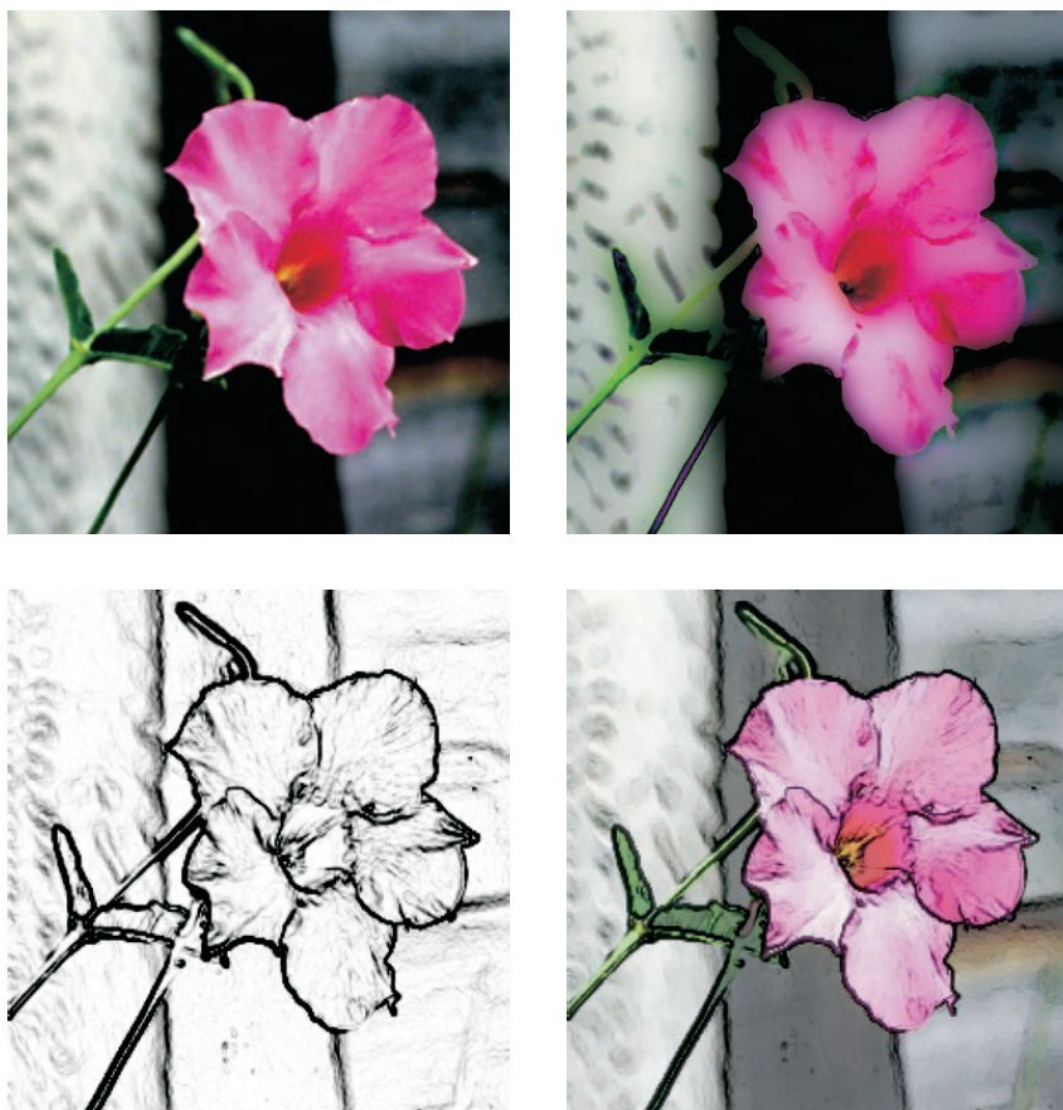
图 26 使用像素着色器进行图像处理。左上为原始图像；右上角为高斯差分操作的图像，左下为经过边缘检测的图像，右下为边缘检测与原图像的混合。
