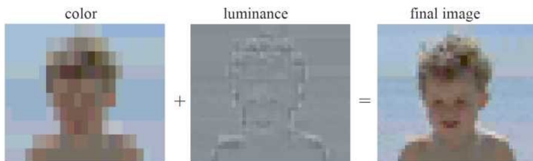
图 12 ETC 算法对像素块的颜色进行编码，然后修改每像素的亮度以创建最终的纹理颜色
