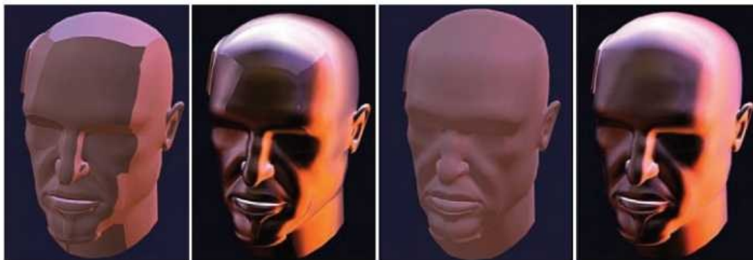
图 10 立方体贴图过滤。最左边两个图像使用 2 \times 2 和 4 \times 4 的立方体贴图的纹理层次，采用标准立方体贴图生成 mipmap 链。因接缝显而易见，除了极端细化的情况，这些 mipmap 级别并不可用。两个最右边的图像使用相同分辨率的 mipmap 级别，通过在立方体面和采用角度范围进行采样生成。由于没有接缝，不易失真，这些 mipmap 甚至可以用于显示在很大的屏幕区域的对象。
