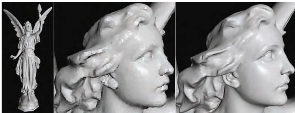
图 29 根据点渲染的方法渲染出来的模型，使用原型油彩（circular splats）。左图为名为 Lucy 的天使模型，拥有 10 万个顶点。但在渲染中只用到了 300 万个油彩，中图、和右图是对左边图的放大。在渲染中，中间的图像使用 4 万个油彩，当视点停止移动时，就变成了右图，使用了 60 万个油彩（此图由 Szymon Rusinkiewicz 的 QSplat program 产生，Lucy 的模型来自斯坦福图形实验室）
