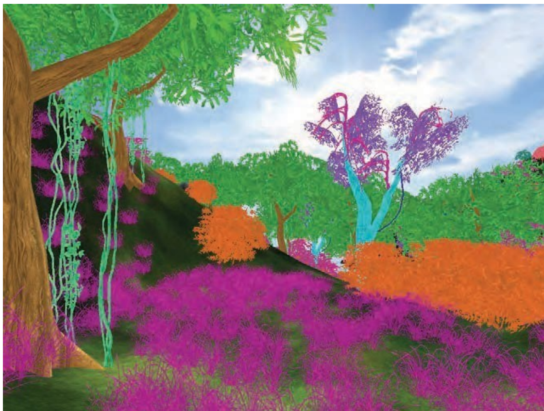
图 4 植被实例（Vegetation instancing）。所有同样颜色的物体在一个 Draw Call 中进行渲染。
