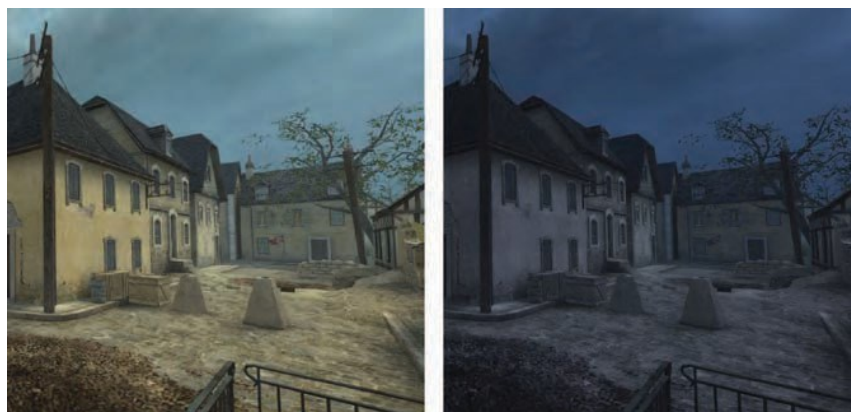
图 27 左图是准备进行颜色校正的原图。右图是通过降低亮度，使用卷积纹理（Volume Texture），得到的夜间效果。@Valve
