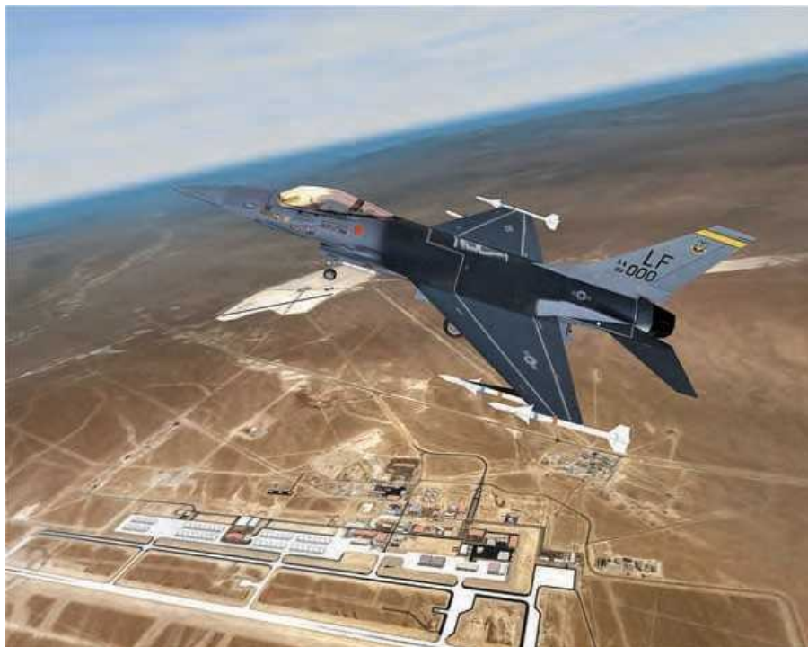
图 11 高分辨率地形图访问海量图像数据库。使用 clipmapp 技术可以减少在同一时间所需数据量。
