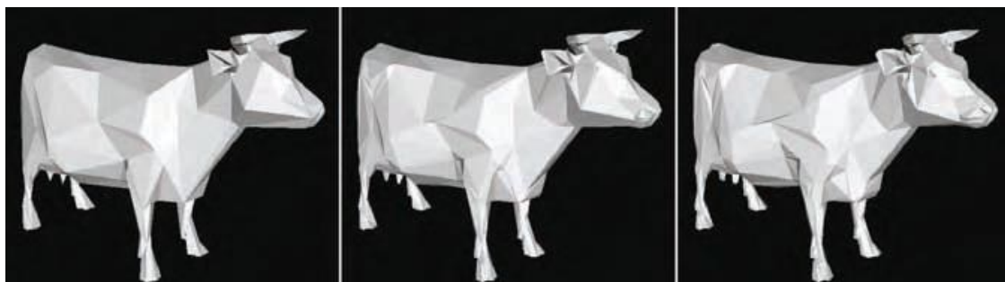
图 26 几何形变 LOD 的简化模型图示。左边和右边的图像所示分为为低细节层次和高细节层次的模型，中间的图像是在左右模型中间进行插值生成的几何变形模型。注意。中间的牛模型和右边的模型具有相同数量的顶点和三角形。
