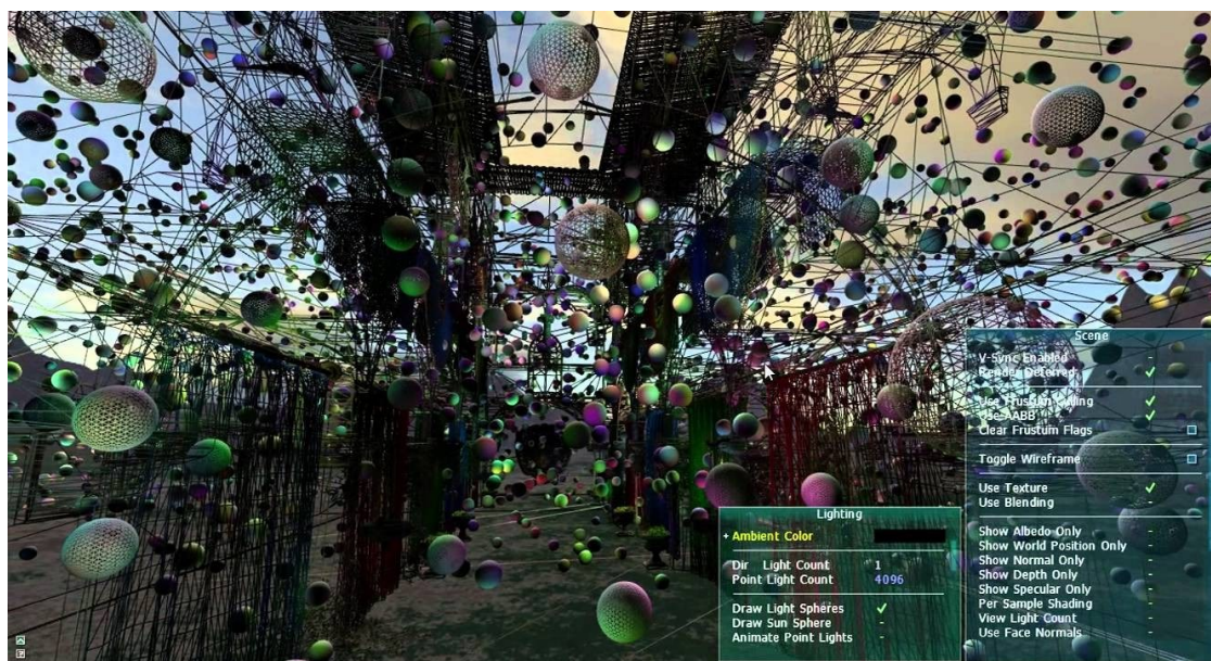
图 16 使用 Tile-Based Deferred Rendering 思路渲染的场景，场景含 4096 个点光源
