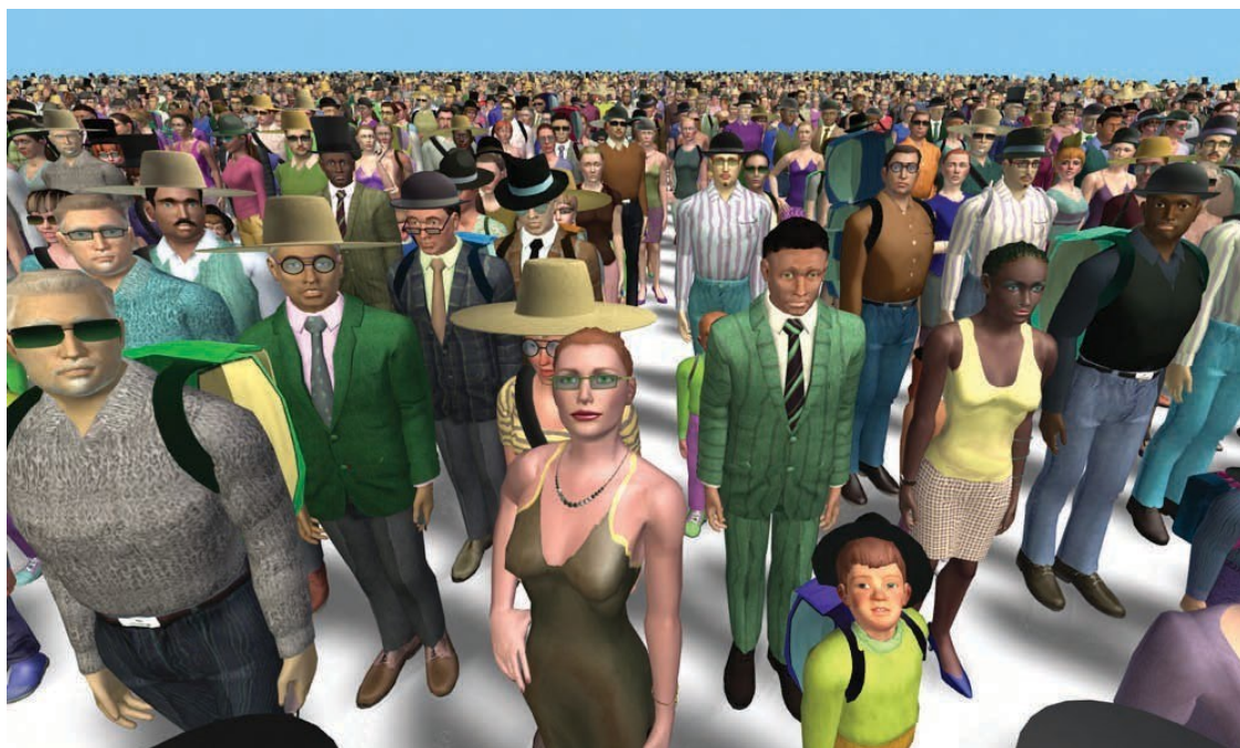
图 5 多人同屏场景（crowd scene）。使用实例（instancing）来减少 Draw Call，也可以结合 LOD 技术使用，比如对于远处的模型，使用 impostors 进行渲染。
