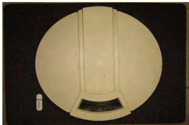
圖三 A、HP12869 匣式磁碟，容量 2.4MB，USB 隨身碟容量 16GB。
