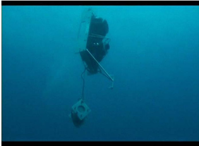
圖 1、庭園鳥收到回收信號後，擺脫底錨，以 0.8 m/s 的速度浮向海面，拖在尾巴的是感震器。感震器外掛，源自 WHOI 的基因。WHOI 精緻優游的工程文化，也多少傳給了 OBS 團隊。
