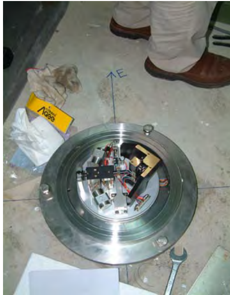
圖 1、STS-1 超寬頻地震儀內部結構。裝設之後，機內抽真空，全站不再移動（劉忠智研究技師提供）。
