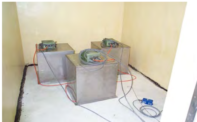
圖 3、BATS 鎮山之寶，STS-1 超寬頻三向地震儀裝設完成後狀態（劉忠智研究技師提供）。
