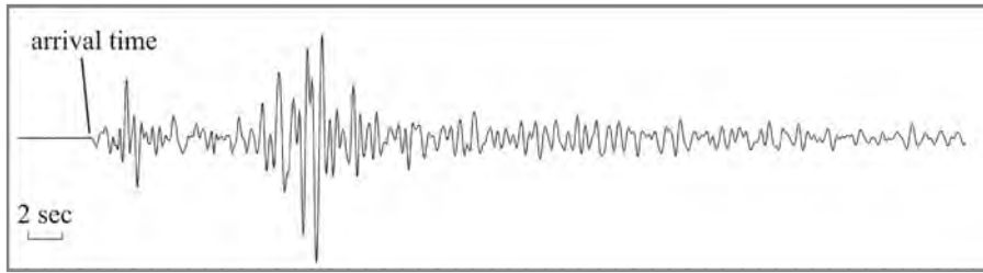
圖一、地震觀測儀記錄到的震波波形。射線法使用震波起始時刻 (arrival time) 來逆推射線路徑上的結構，全波場方法則是用整個波形(或某一個時間段內的波形)來逆推地球內部構造。
