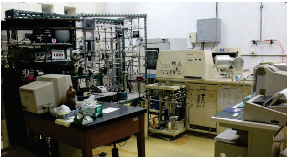
上圖為本所穩定同位素實驗室之一。圖中為穩定同位素比值質譜儀及標本氣體雷射萃取系統。
