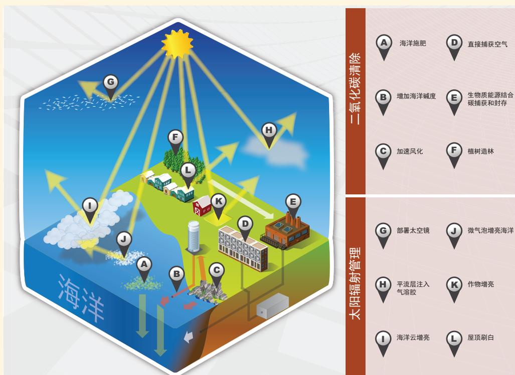
**常见问题7.3，图1 | 部分拟议的地球工程方法概况。**二氧化碳消除法（详见6.5节）：(A)向海洋中添加养分（海洋施肥），提升海洋表层生产率，且向海洋下方运送少量随之产生的生物碳；(B)向海洋中添加从固体矿产中提取的碱，使更多大气中的二氧化碳溶于海洋；(C)硅酸盐岩石侵蚀率上升，溶解的碳质矿物流向海洋；(D)以化学方式获取大气中的二氧化碳，储存于地下或海洋中；(E)发电厂利用碳捕获燃烧生物质，捕获的二氧化碳储存于地下或海洋中；(F)通过植树造林和植树还林进行二氧化碳捕获，储存于陆地生态系统中；太阳辐射管理法（详见7.7节）：(G)在太空中放置反射器反射太阳辐射；(H)向平流层中注入气溶胶；(I)为增强反射率而播种海洋云；(J)为增强反射率而在海洋表层制造微气泡；(K)种植更多反光作物；(L)将屋顶和其他建筑结构刷成白色。
